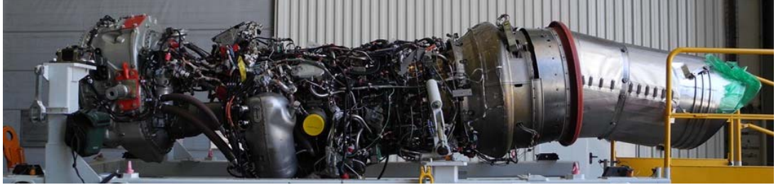
A400M Uçakları TP400D Güç Grubu ve Dişli Kutusu © MSI
