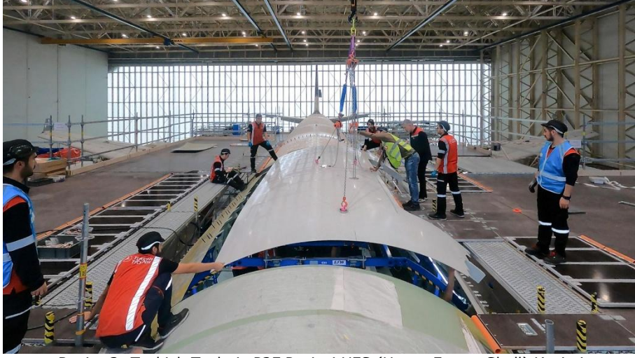
Resim 3: Turkish Technic P2F Projesi UFS (Upper Frame Shell) Kesimi
