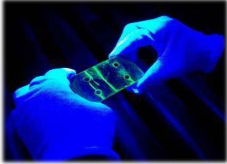
FPI son aşaması; hazırlanmış yüzeyde göz kontrolü ve ölçme ile karar verilmesi
