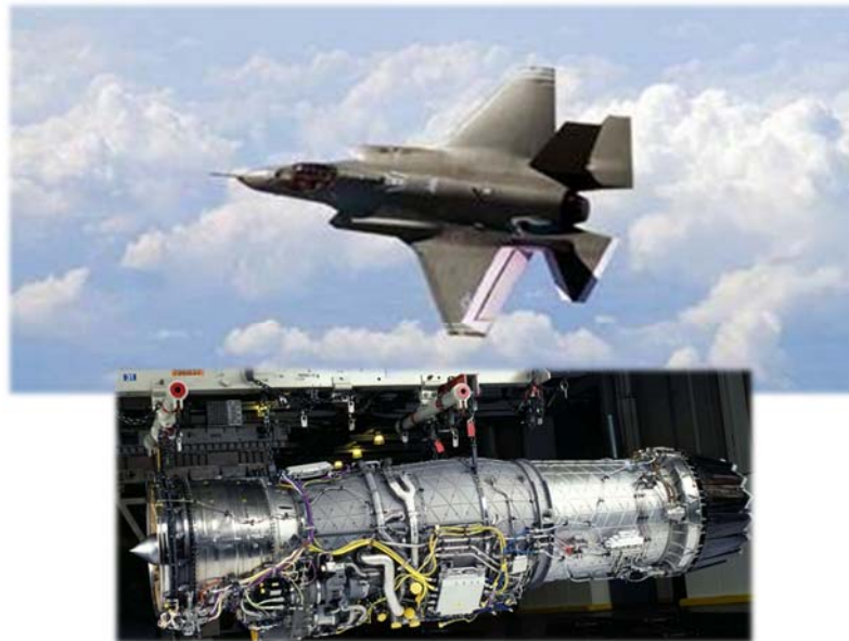
F-35 Lightning II (JSF) Uçağı F135 Motoru © AFP & JSF.mil
